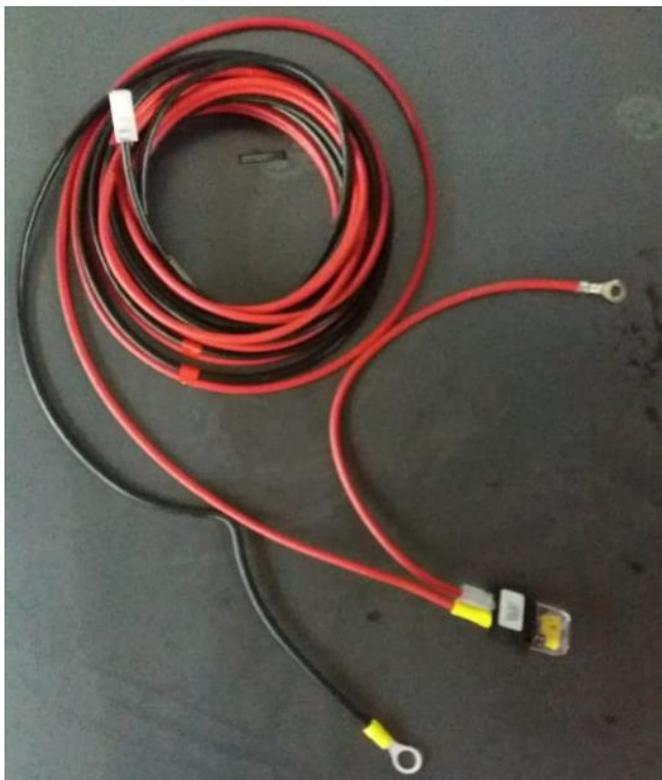
APÓS A FIXAÇÃO DO EQUIPAMENTO NO PISO, PASSAR O CABEAMENTO ATÉ A BATERIA, POR PONTOS ONDE FIQUEM DISCRETOS. CORTA O EXCESSO DE CABOS E FAZER A LIGAÇÃO DOS CABOS UNINDO-OS A BATERIA
