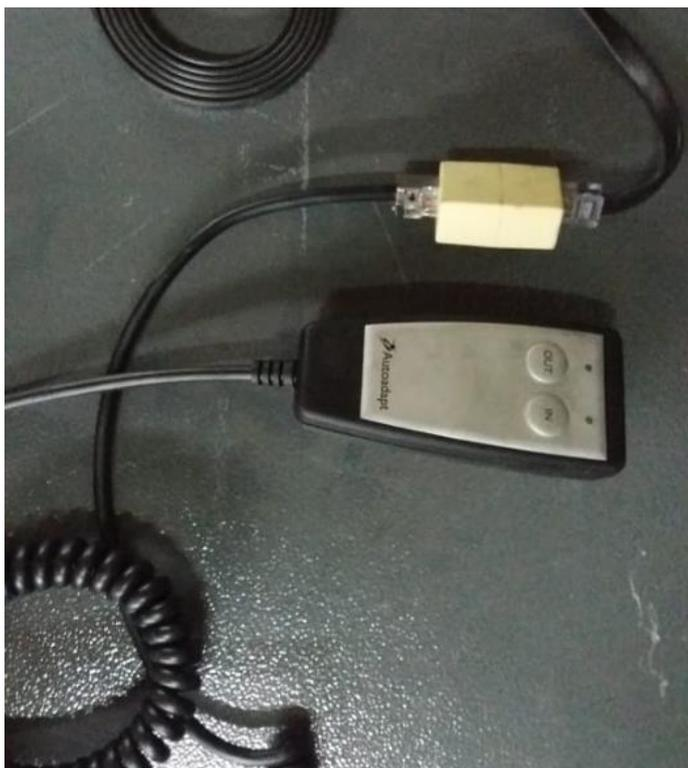
**Conectar o cabo do controle no chicote do Turny Orbit Van, e esta pronto para a operação e testes.**
